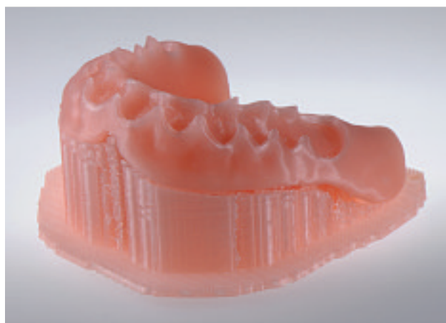
Abb. 21: Mit dem FilaPrintM Dental Desktop 3-D-Drucker additiv gebaute Prothesenbasis und Zahnkranz aus Eldy Plus – Materialien (DentalPlus GmbH, Samerberg, D)
