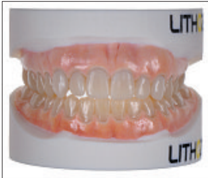
Abb. 23: auf Basis eines Intraoralscans im Multimaterial-3-D-Druck (Polyjet, Stratasys) hergestellte mehrfarbige fotorealistische Modelle
