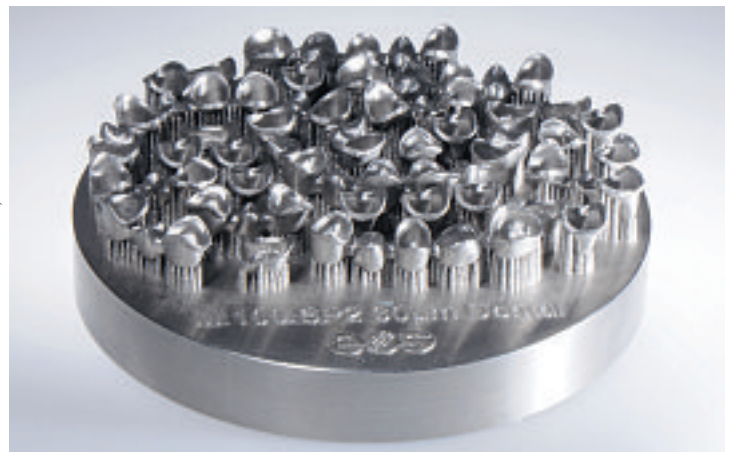
Abb. 17: Bauplattform mit lasergesinterten Kronen- und Brückengerüsten aus einer CoCr-Legierung
