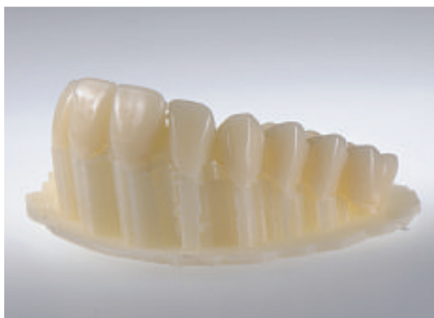
Abb. 21: Mit dem FilaPrintM Dental Desktop 3-D-Drucker additiv gebaute Prothesenbasis und Zahnkranz aus Eldy Plus – Materialien (DentalPlus GmbH, Samerberg, D)
