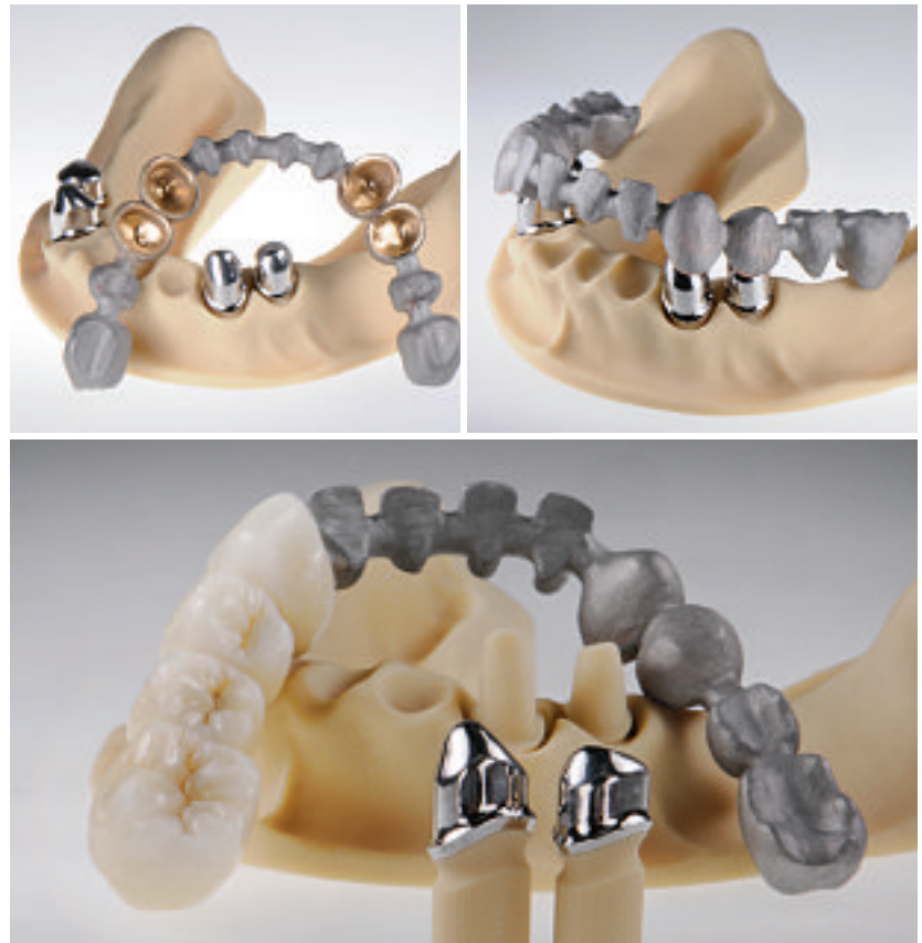
Abb. 27–29: Teleskopversorgung im Unterkiefer aus einer Goldlegierung und einer CoCr-Legierung, gleichzeitig zusammen hergestellt in einem Bauprozess mittels Metall-Multimaterial-3-D-Druck
