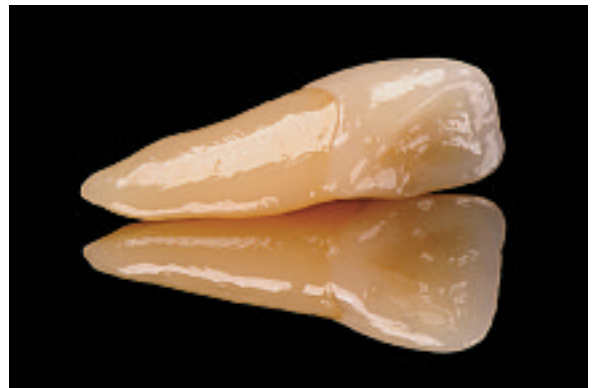
Abb. 26: Mittels Lithoz LCM-Verfahren (LCM = Lithography-based Ceramic Manufacturing) gefertigte, dreidimensional geschichtete Zähne aus Lithiumdisilikat
