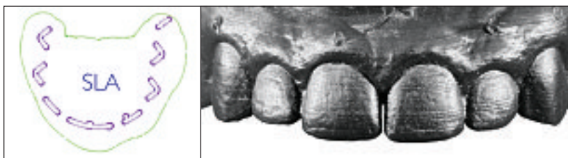
Abb. 12: SLA-Verfahren weisen aufgrund der schichtweisen Belichtung durch die Laserstrahlspur eine Stufung nur in Z-Richtung auf.
