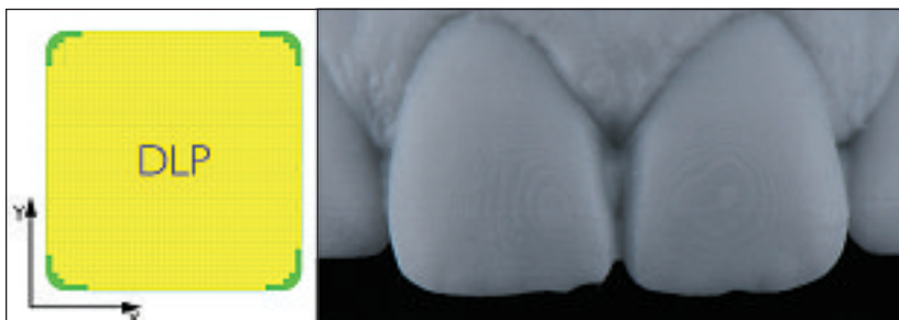
Abb. 11: DLP-Verfahren zeigen aufgrund der schicht- und pixelweisen Belichtung eine XY- sowie eine Z-Stufung.
